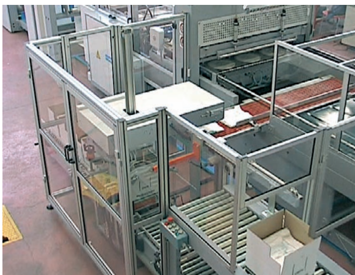
Figura 6 Sistema di trasporto delle mazzette dopo l'inscatolamento automatico
