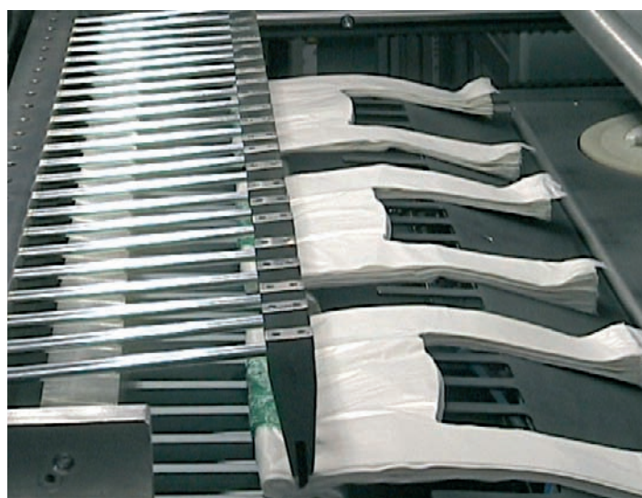
Figura 3 Le mazzette di sacchetti suddivise in tre "piste" dopo il passaggio nella stazione di taglio per produrre i manici
